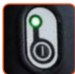
Aan/uit knop met deblokkerings-systeem en led
